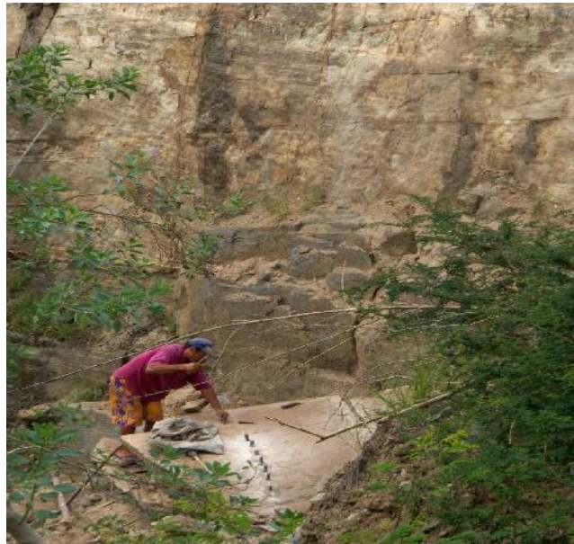
Figura 3. Foto da rocha sendo preparada para o 'corte', com destaque para o trabalhador sem nenhum Equipamento de Proteção Individual (EPI). Fonte: Pesquisa Direta (junho, 2011). Foto: CABRAL, L.
