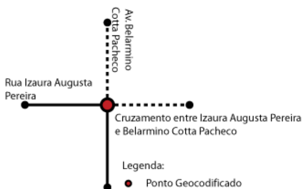
Figura 6 - Geocodificação de cruzamento. Utilizado quando o algoritmo é alimentado por um endereço no formato Via 1 com Via 2. Fonte: SILVA, G. R. C., Desenvolvimento do software SigmaTT, 2009
